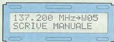
Fig.38 Per modificare una frequenza di tipo "R", scrivete sul display la nuova frequenza, poi fate apparire la scritta Scrive Manuale . Premendo ENTER la memoria W05 verrà cambiata.
