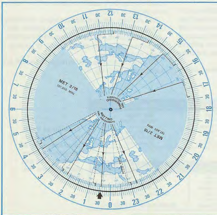
Fig.10 Per i satelliti Russi dovrete inserire il dischetto delle orbite relative al satellite ricercato partendo da un dato di riferimento (vedi Tabella N.1). Noterete che questo satellite il giorno DOPO si sposta verso Ovest (vedi linea tratteggiata).
