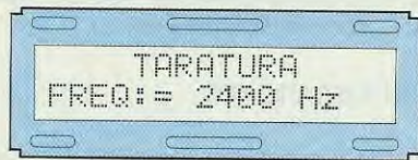
Fig.50 Come qui sopra illustrato, il ricevitore è in grado di leggere la frequenza del Decoder che potrete correggere ruotando il trimmer R19 sull'LX.961.
