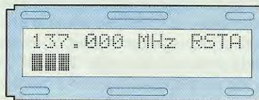
Fig.33 Premendo Enter questa frequenza verrà memorizzata e sulla destra del display apparirà la scritta RSTA .
