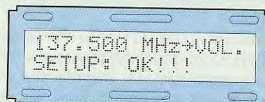
Fig.49 La scritta SETUP OK che appare quando si preme il tasto ENTER sul Volume , l' AFC , il Relè , la velocità di Scansione , serve per indicare che quanto prescelto è stato memorizzato.
