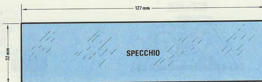
Fig. 9 Per realizzare questo caleidoscopio sono necessari tre specchietti da 32 x 127 mm., che congiungerete con del nastro adesivo in modo da formare un prisma, che poi applicherete entro al mobile (vedi fig. 3).
