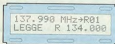
Fig.42 Per la sintonia Manuale dovreste premere il tasto FUNZ. fino a far apparire in basso la scritta LEGGE.
