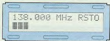
Fig.35 Premendo Enter, sulla destra del display vi apparirà RSTO. NOTA: la frequenza WSTO deve essere maggiore della WSTA.
