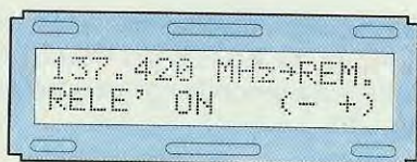
Fig.48 Per eccitare il relè quando capterete un segnale, fate apparire sul display la scritta Relè , poi premete i tasti +/- e su ON premete ENTER fino a far apparire SETUP OK (fig.49).
