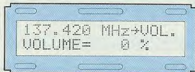
Fig.46 Per dosare e memorizzare il livello del VOLUME fate apparire questa scritta, poi scelta la percentuale premete ENTER e tenetelo premuto fino a quando non apparirà SETUP OK
