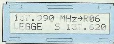
Fig.43 Premendo Enter, sulla prima riga del display vi apparirà la frequenza di 137.620 MHz e sulla seconda il Vu-Meter.
