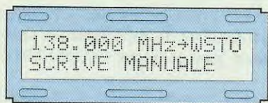
Fig.34 Sempre in Scrive Manuale, premendo i tasti +/- quando appare WSTO, potrete memorizzare la frequenza di stop della Scansione in Frequenza.
