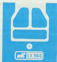
Fig.5 Dimensioni a grandezza naturale del circuito stampato e relativo schema pratico. I due cavetti coassiali Entrata e Uscita possono essere anche invertiti perchè il filtro è simmetrico.
