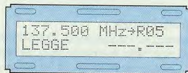
Fig.37 Una volta rilasciato il tasto FUNZ. , la memoria è cancellata. Se leggerete la R05 , la riga in basso apparirà vuota.
