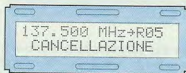
Fig.36 Quando appare questa scritta, è in atto la cancellazione della frequenza indicata sul display (ad esempio R05, ecc.).
