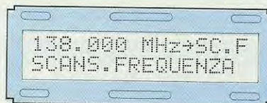
Fig.45 Per la scansione automatica sulla gamma RSTA-RST0 (vedi figg.33-35), premete il tasto FUNZ . fino a far apparire SCANS.FREQUENZA , poi il tasto ENTER .
