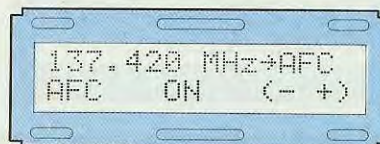
Fig.47 Per inserire e memorizzare l' AFC , premete il tasto FUNZ . fino a quando non apparirà sulla seconda riga AFC , poi il tasto + e quindi il tasto ENTER fino a far apparire SETUP OK (vedi fig.49).
