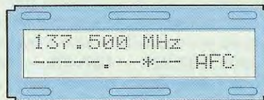
Fig.28 Premendo contemporaneamente i tasti FUNZ/ENTER, sulla seconda riga vi apparirà l'asterisco dell'AFC.
