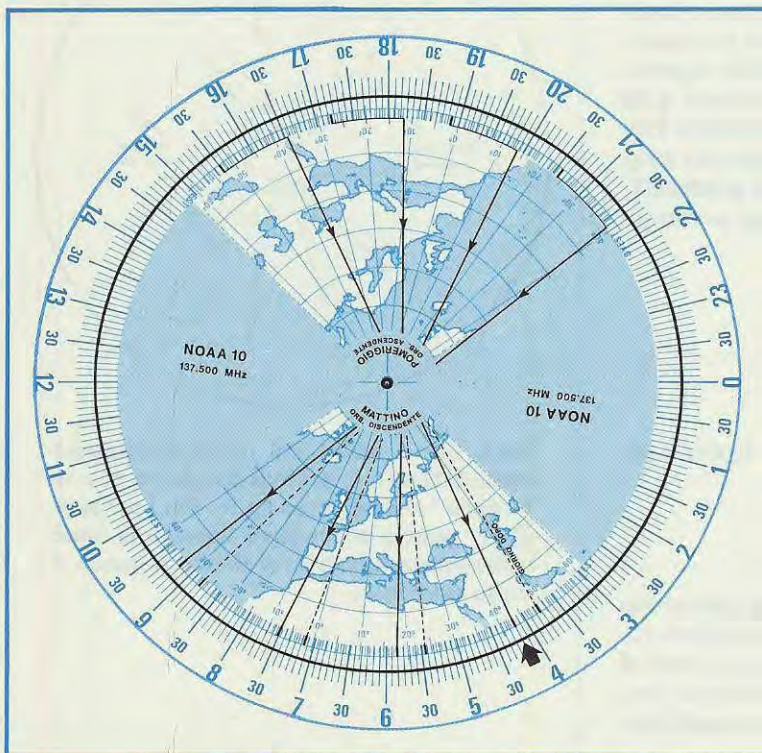
Fig.7 Se il satellite NOAA 10 il giorno 20 gennaio alle ore 4.09 passa alla longitudine di 43° Est, facendo coincidere i gradi della cartina geografica con quelli dell'orbita, potrete conoscere l'ora ed i gradi di longitudine dei successivi passaggi del mattino e del pomeriggio.
