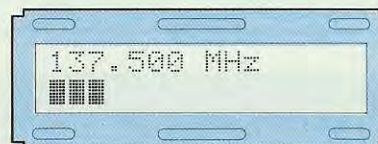
Fig.25 Trascorsi questi pochi secondi, sul display vi apparirà questa frequenza e le barre del Vu-Meter.
