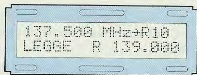
Fig.40 Per modificare una frequenza di tipo "R" in una di tipo "S", fate apparire sulla seconda riga la frequenza da modificare.
